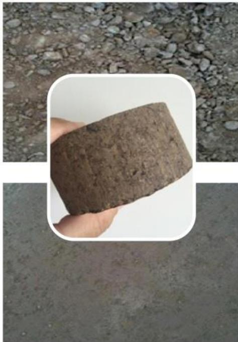
*Bio Polímeros eco amigables solubles en agua que se fusionan con las partículas del suelo para crear una misma masa polimerizada que coadyuva al mejoramiento de su estructura.*
